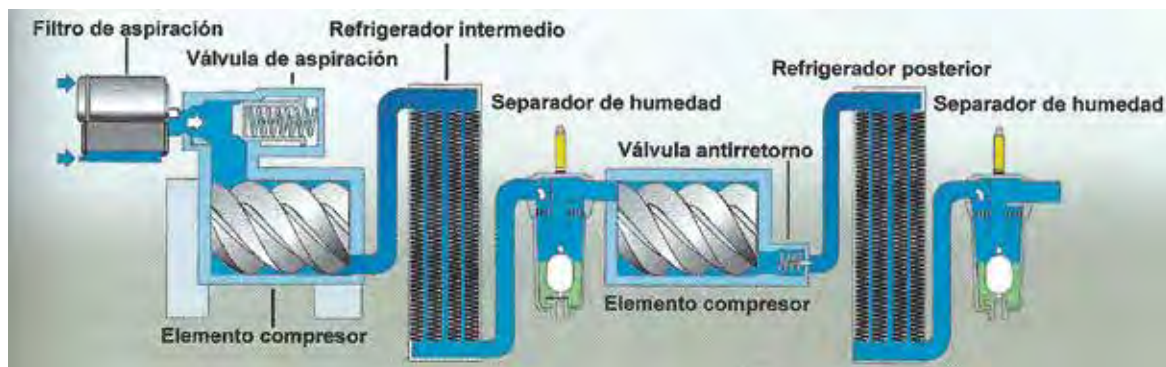
Fig. 7. Compresor exento o oil free (más eficientes a largo plazo a partir de cierto tamaño)*
